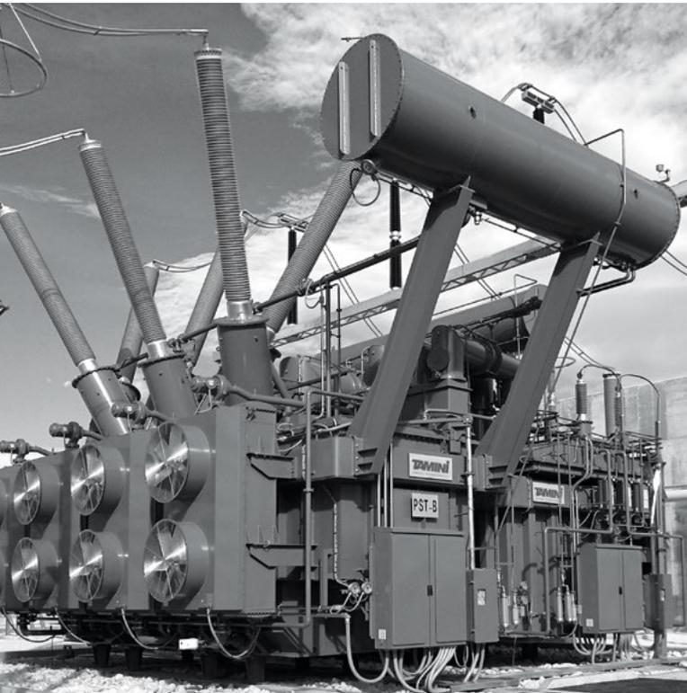
**d)** Un'altra applicazione speciale sviluppata da Tamini è un autotrasformatore da 150/200 MVA con **tensione primaria** di 330 kV e **secondaria** di 161 kV  $\pm 8 \times 1,25\%$  (con commutatore sotto carico per la regolazione in fase). È inoltre dotato di un commutatore fuori circuito supplementare da  $\pm 2 \times 12$  kV che consente una capacità di spostamento di  $\pm 6^\circ$ . Questo autotrasformatore è l'unico impianto al mondo con tale capacità.
